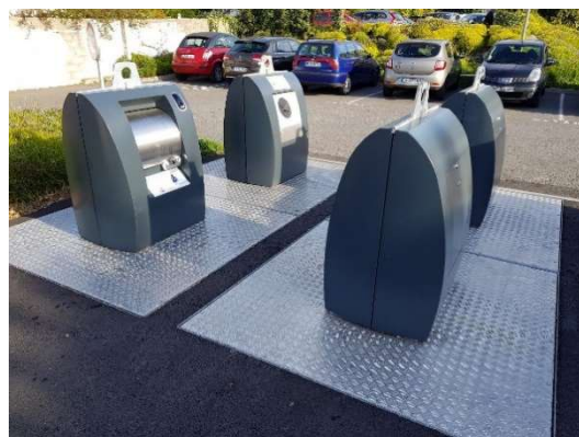
Colonnes enterrées. Quiberon
